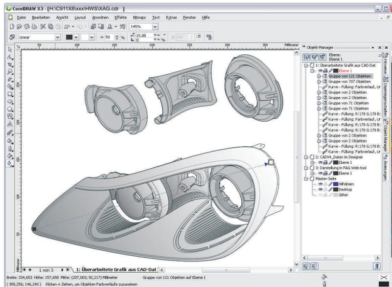
Der Konstrukteur oder technische Redakteur liest in dem Tool Corel DESIGNER Professional ein natives CAD 3D-Modell ein, das nun ohne größeren Aufwand mit dem 3D-Importmodul bearbeitet werden kann. Er kann zum Beispiel Objekte frei drehen, Schnitte anlegen und Vektorgrafiken exportieren.
